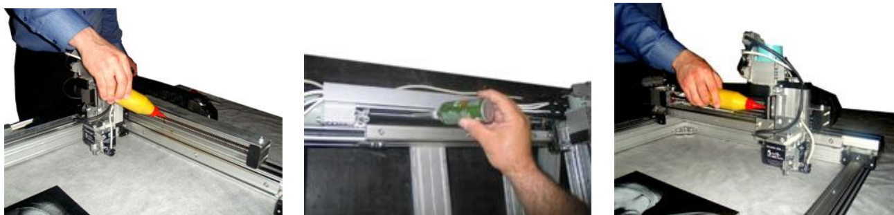
Рис.10.2. Смазка винтов приводов X, Y, Z.
