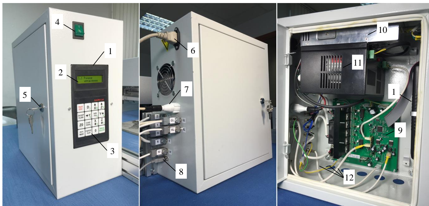
Рис.3.2. Микропроцессорный блок управления.
